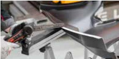
► Rimuovere Ecoat dalle aree della flangia di accoppiamento del pannello di ricambio utilizzando il nastro abrasivo Scotch-Brite™
