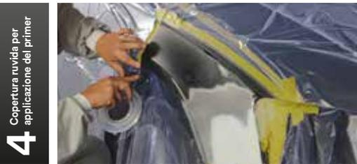
► Per i migliori risultati applicare il nastro per sfumature 3M™ Smooth sopra il nastro di mascheratura 3M per un'applicazione omogenea sui bordi del fondo.
