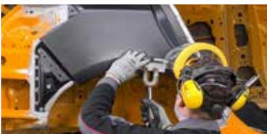
► Installare il pannello sostitutivo sul pannello di alloggiamento mediante fissaggio in posizione
