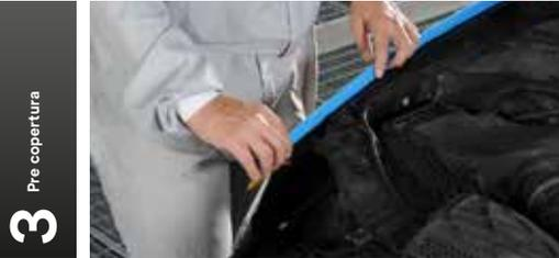
► Preparare l'area per l'applicazione della vernice, garantendo spazio sufficiente per consentire operazioni regolari ed evitare bordi duri.
