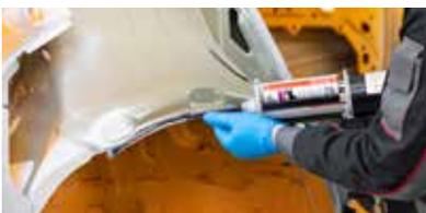
► Applicare l'adesivo sulle aree della flangia di accoppiamento sul pannello di alloggiamento e sul pannello di sostituzione, coprendo tutte le aree di metallo nudo
