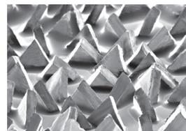
I tradizionali granuli abrasivi ceramici tendono a scavare il metallo, causando lo sviluppo di calore sul pezzo e sull'abrasivo stesso – dando luogo ad un taglio più lento e ad una minor durata del disco.
